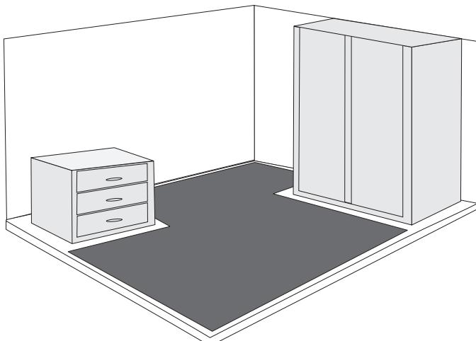
3) Под полученной полезной площадью подберите нагревательный мат, площадь которого примерно равна или меньше площади обогрева. Внимание! Площадь нагревательного мата не может превышать полезную площадь обогрева.
